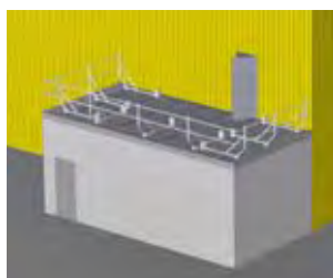
2 Tetto piano con protezione laterale provvisoria
