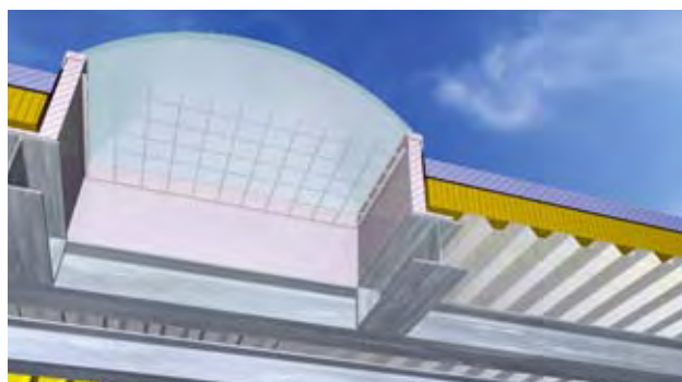
2 Apertura nel tetto (lucernario a cupola) con griglia fissa come protezione permanente
